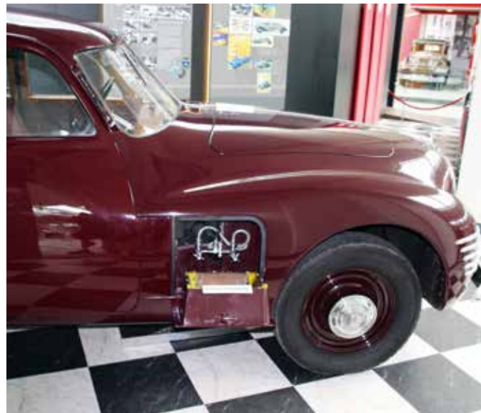
Varmtvannskran i høyre forskjerm.
